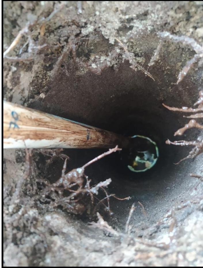
Gambar 4.4 Lubang biopori diukur menggunakan pipa dengan kedalaman 70 cm tanah sudah tercampur dengan air
