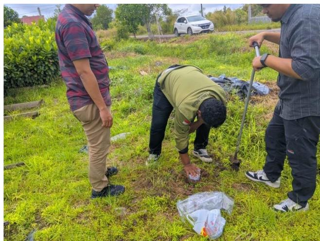
Gambar 4.2. Proses Pemboran Tanah dengan Bor Tanah Manual/*Hand Auger*
