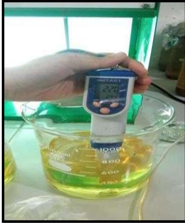
Gambar 4.4 Pengukuran pH Air Gambut Sebelum Dilakukan Proses Pengolahan Menjadi Air Bersih
