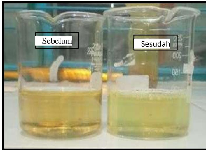
Gambar 4.6 Perbedaan Warna Sebelum dan Sesudah Dilakukan Pengolahan Pada Air Gambut Menggunakan Koagulan Alami
