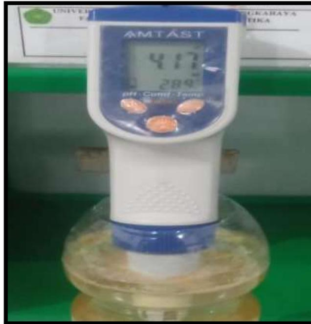
Gambar 4.5 Pengukuran pH Air Gambut Sesudah Dilakukan Proses Pengolahan Menjadi Air Bersih
